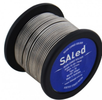
Diam_1.21mm Grade : Sn60 / Pb40 Type : 35 SA 942
